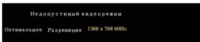
Это значит, что монитор не может синхронизироваться с сигналом, принимаемым с компьютера. Сигнал слишком высок или низок для использования монитором. См. [Спецификации](#) для получения информации о соответствующих диапазонах вертикальной и горизонтальной частоты. Рекомендуемый режим: 1366 X 768 @ 60 Гц.
