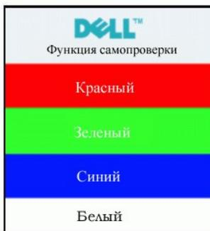
4. Данное окно также появляется при нормальной работе системы при отключении или повреждении видеокабеля.
